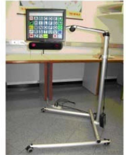
Sistemi optoelettronici che permettono di individuare la direzione in cui viene orientato lo sguardo e utilizzare questa informazione come input al computer
