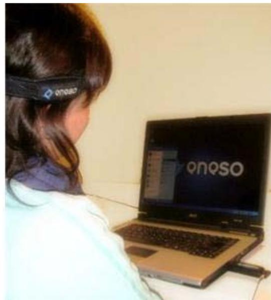
Un dispositivo con all'interno un giroscopio, posizionato sul capo dell'utilizzatore è in grado di rilevarne le variazioni di inclinazione; un software sul PC elabora questa informazione e trasforma i movimenti della testa nello spostamento del mouse sullo schermo.
